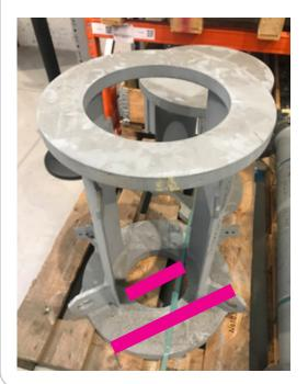
Base Diametro 46 cm. Diametro foro interno 23 cm.
