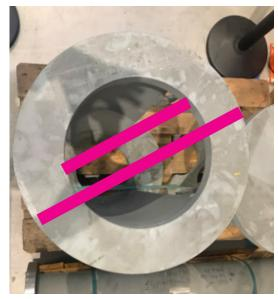
Anello superiore Diametro esterno 46 cm. Diametro foro interno 29 cm.
